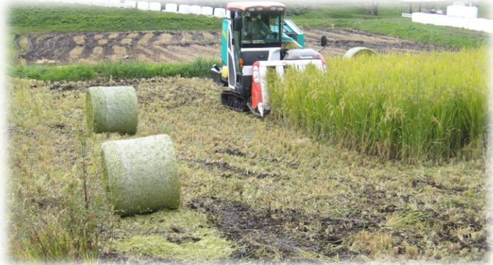
飼料稲を刈取りながら梱包する専用の収穫機械で作業実施
