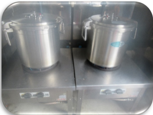
①27kgの大豆を煮ます。（2つの鍋で3回煮ます） ※煮かたにより色が左右されるとのこと、農産では圧力鍋を使用することで、赤く粒感のある味噌ができます。
