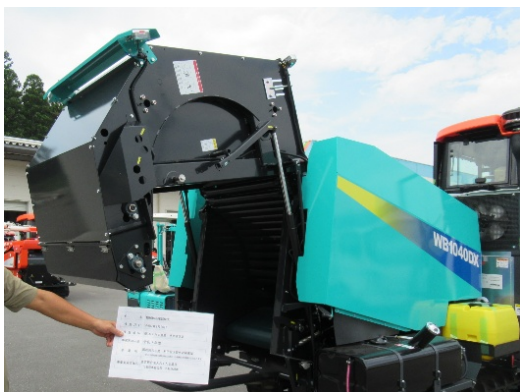
👉 機械後部で稲が梱包されます。(1m×1m) コンバインとロールベアラがひとつになった機械
